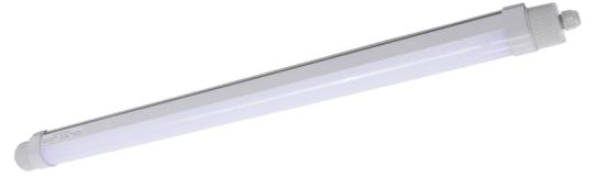
Auslaufartikel: LED-Feuchtraumleuchte, Serie VASCA ECO, IP66, IK08. Gehäuse und Seitenteile aus Polycarbonat, grau. Opaler Diffusor aus PC, UV-resistent. Symmetrische Lichtverteilung und homogene Ausleuchtung. Durchgangsverdrahtung vorhanden. Betriebsgerät integriert, schaltbar.
