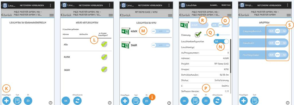
**i** **Tip:** Kennzeichnung jeder Leuchte durch eindeutige 4-stellige Geräteadresse. Identifikation im laufenden Betrieb mittels Blinkfunktion (ID).
